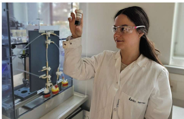
Laura Hermann, Projektleiterin Forschung und Entwicklung bei der EnBW, mit einer Probe des Filtermaterials. Es hält das Lithium aus dem Thermalwasser fest und lässt die übrigen Salze durch.
