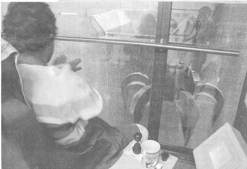
Dans sa cabine de pilotage, le grutier pilote avec la vidéo un bras articulé afin de mélanger les déchets, puis de les envoyer dans le circuit d'incinération. (Photo DNA - M.H.)
